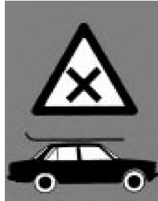
Intersecția cu un drum carosabil
